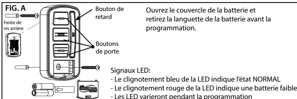
Ouvrez le couvercle de la batterie et retirez la languette de la batterie avant la programmation.
