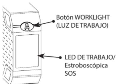
La LUZ DE TRABAJO se apagará automáticamente después de 120 minutos.
